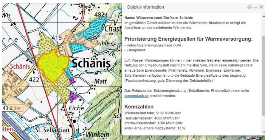
Abbildung 9: Beispiel aus dem digitalen Wärmeplan und Darstellung zu Details des Wärmebedarfes und möglicher Energiequellen im gewählten Gebiet
