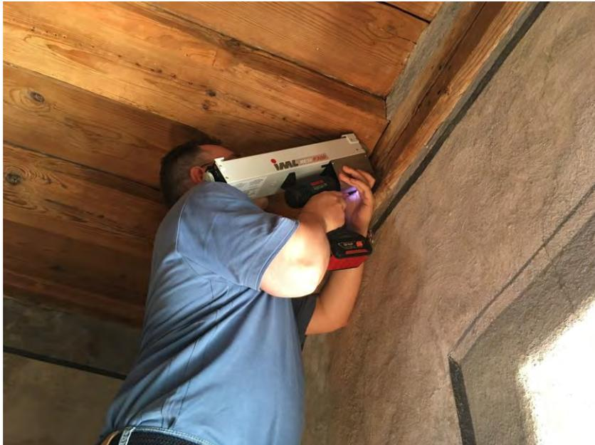
Holz Bohrwiderstandsmessungen zeigen, wo schadhafte Bereiche liegen. Dort kann dann gezielt das Bauteil geöffnet und entschieden werden, ob das Holz ersetzt werden muss!
